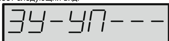
5.20.2 Процедура «ВОССТАНОВЛЕНИЕ ЗАВОДСКИХ УСТАНОВОК» позволяет восстановить в Блоке в качестве рабочих заводские установки точек калибровки, коэффициентов и флагов.
