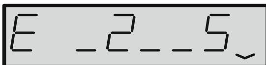
5.12.2 Для коррекции величины электропроводности в текущем поддиапазоне Блок переводится в режим «Коррекция». Окно индикации при этом приобретает следующий вид:
